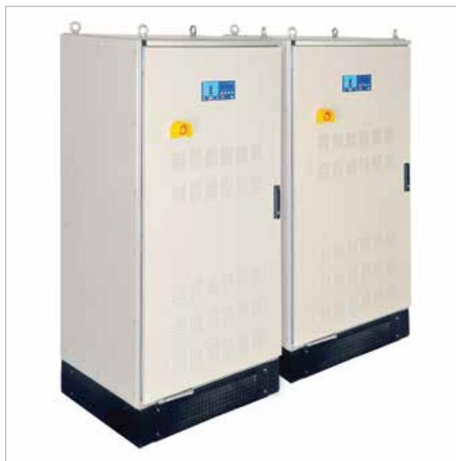
KFK33-P Model 400Hz Statik Frekans Konverterleri 800m mesafeye kadar yalnızca haberleşme kablosu çekilerek N+1 sayıda paralel yük paylaşımı olarak senkron modda çalışabilmektedir. Paralel çalışma esnasında konverterlerin yük paylaşımları arasındaki fark %5 'ten az ve aktif reaktif güç paylaşımı MIL-F-24638 Standartlarına uygundur.
